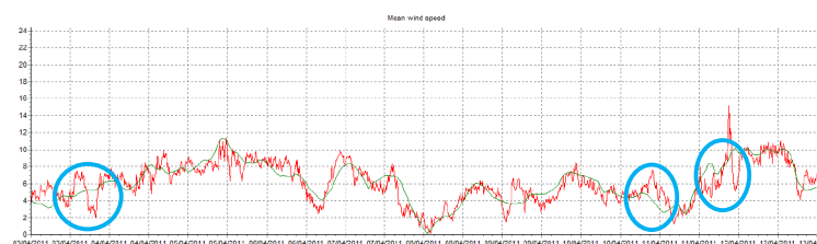
Figure 10: Analyse détaillée des différences de vitesses de vent mesurées et MERRA. Les périodes de temps où des différences notables sont présentées en bleu
