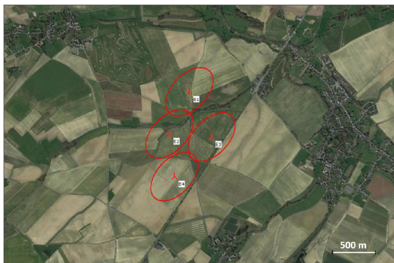
Figure 5 : Implantation du parc éolien et les ellipses indiquant l'espacement recommandé – configuration SG 3.4-132.
