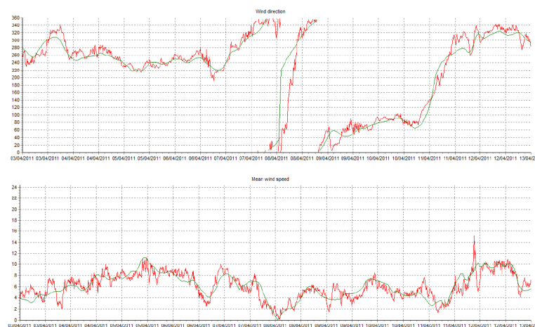
Figure 9: Comparaison des directions (en haut) et vitesses (en bas) mesurées par un mât de mesures en Belgique (en rouge) et issues des données MERRA (en vert) durant les 10 premiers jours de la campagne de mesures
