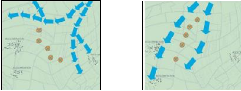
Figure 1 : Représentation de l'impact différent de deux configurations d'un hypothétique parc éolien sur le déplacement des oiseaux (source : André et al. 2006).
