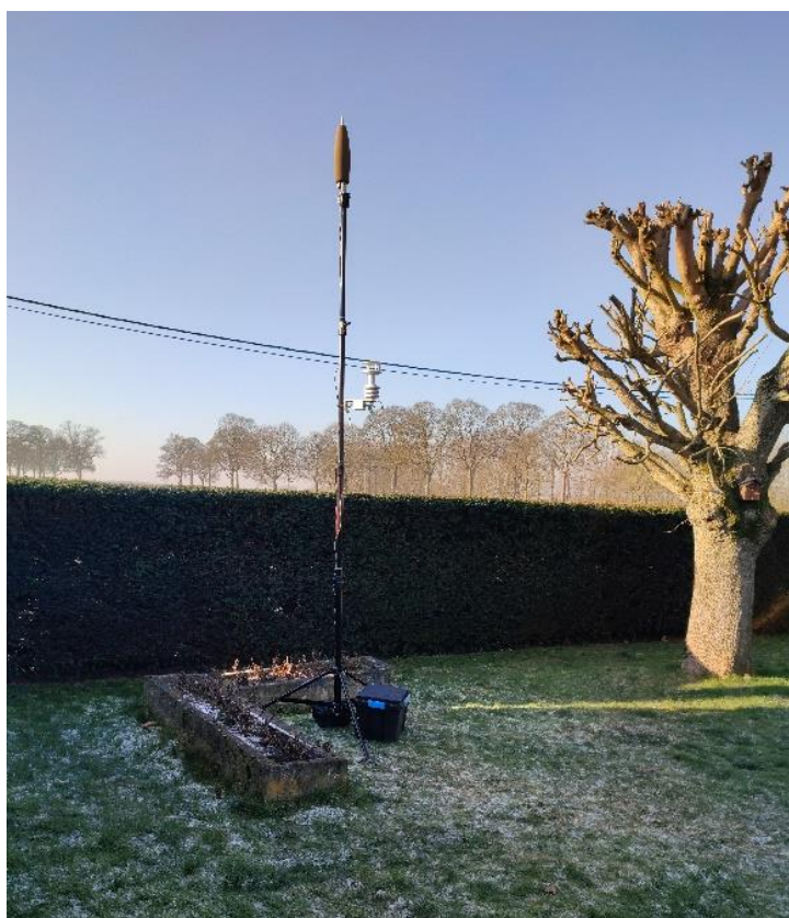
Figure 2 : installation du sonomètre et de la station météo dans le jardin de l'habitation.
